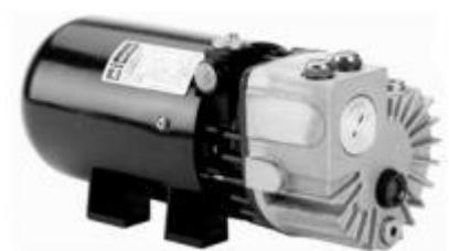
Пластинчато-роторный вакуумный насос BUSCH PB 0008 (А,В) с замкнутым режимом смазывания предназначен для циклического откачивания воздуха до давления 2 мбар. Мощность двигателя 0,35 кВт.
